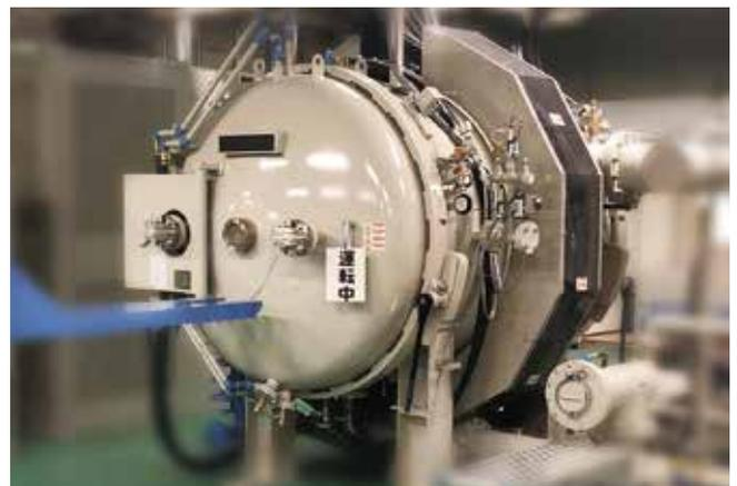
窒化アルミニウム製品を製造する焼成炉
