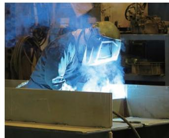
※2 橋梁工事における接合には、主に2種類、ボルトによる接合と溶接による接合があります。今回のような厚板を使用する際には、ボルト接合ではボルトの長さが長くなり過ぎることや本数が多くなるため、景観性やメンテナンス性に優れた溶接接合が採用されています。
