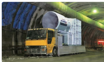
トンネル工事用電気集じん器(e-DUSCO)
