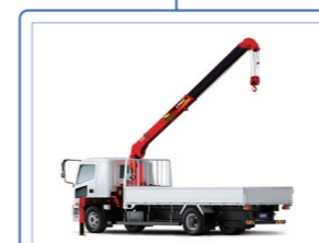
ユニッククレーン
