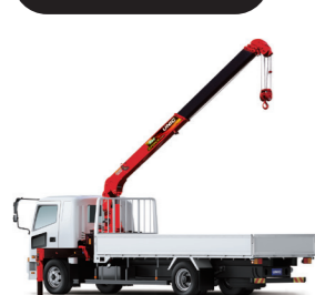
ユニッククレーン
