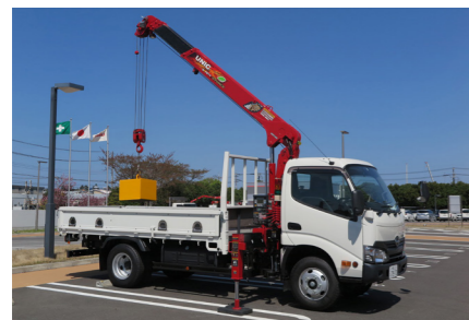
ユニッククレーン
