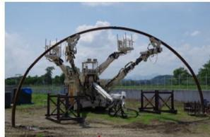
鋼製支保工建込みロボット(前田建設工業株式会社、マック株式会社と共同開発)
