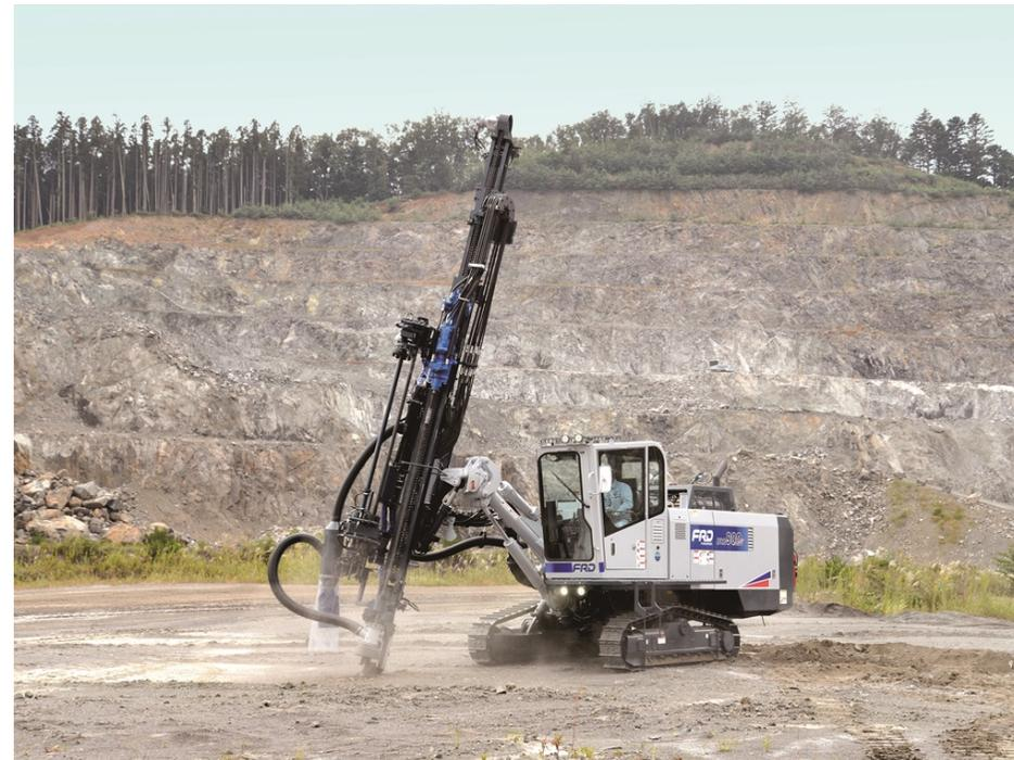
露天掘り鉱山の岩盤に発破用の火薬を装填する孔をあける機械。油圧クローラドリルやダウンザホールドリルなどがあり、主に碎石、石灰石の採掘現場で使用されます。
