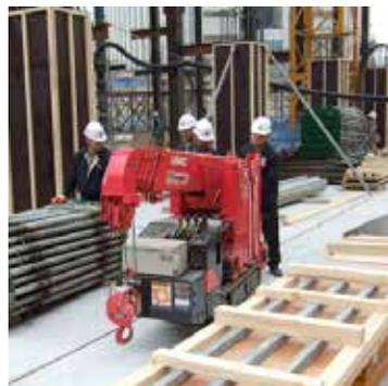
コンパクトで自走可能なミニ・クローラクレーンは、建設現場や屋内の狭いスペースで作業可能なため、欧米を中心に用途開拓が進む
