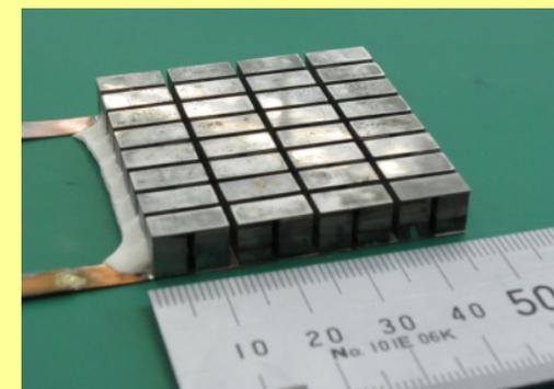
熱電変換モジュール
