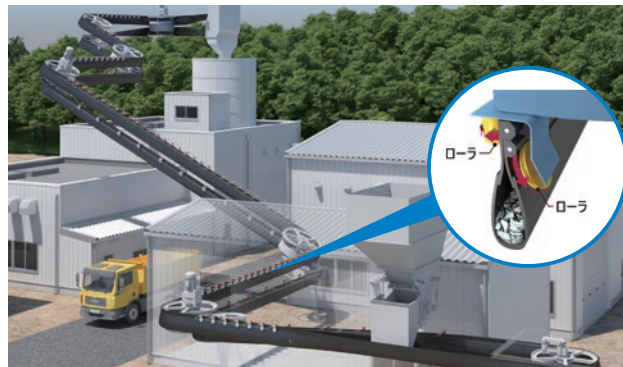
密閉式吊下げ型コンベヤ(SICON®)イメージ図
