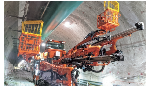
全自動ドリルジャンボ「ROBOROCK®(ロボロック)」
