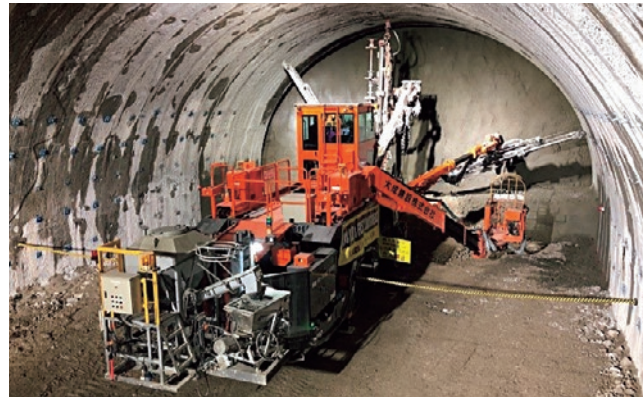
ロックボルト施工機「BOLTINGER(ボルティンガー)」
