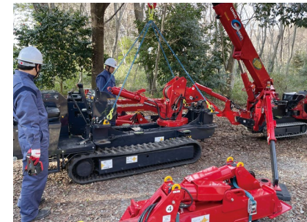
分解式クレーン 山岳地での組み立て作業
