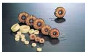
電源や車の電子制御装置などに使用されているコア・コイル
