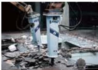
油圧ショベルに装着する油圧ブレーカは岩盤破碎、コンクリート破碎等で高い実績があります
