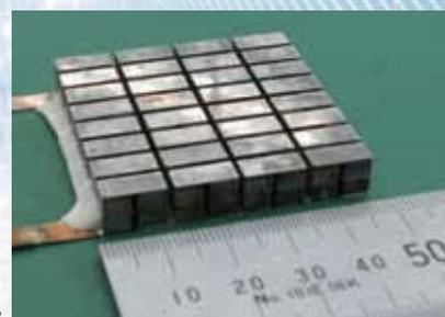
熱電変換モジュール
