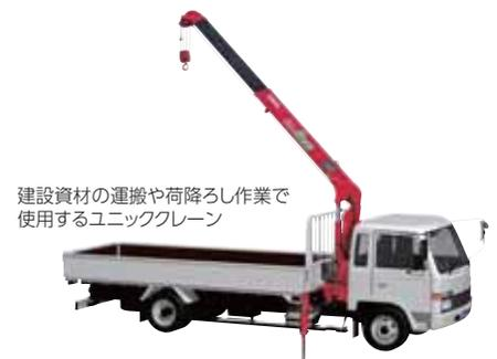
建設資材の運搬や荷降ろし作業で使用するユニッククレーン
