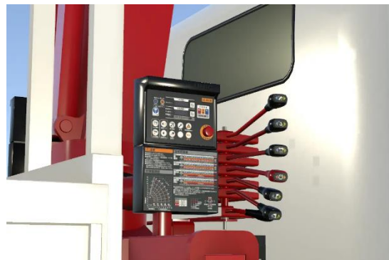
集中コントロールパネル周りも完全に再現しています
