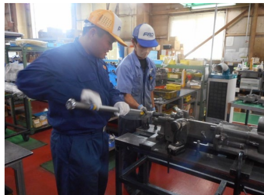
ドリフタの組立体験
