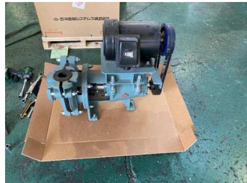
② 段ボールパレットにポンプ固定
