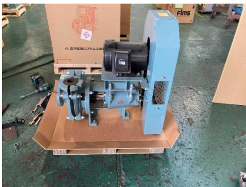
③ ベルトカバー取付後、完成
