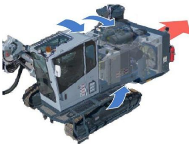
図 2 吐出式クーリングシステム
