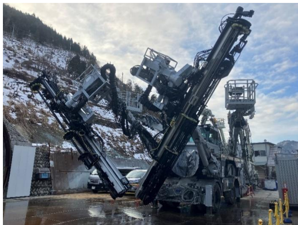
2 ブームロックボルト打設ロボット『ボルティンガー』B22RL-i 提供：鹿島建設（株）
