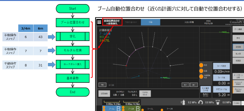
穿孔位置の位置合わせとロックボルト打設の自動操作画面
