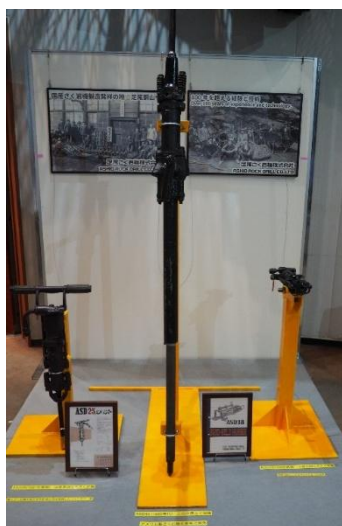
足尾式空圧さく岩機 3 台
