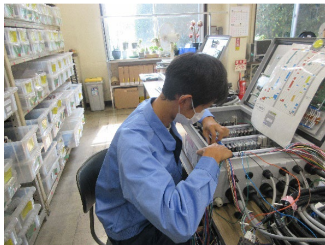
油圧クローラドリルの制御盤組立体験
