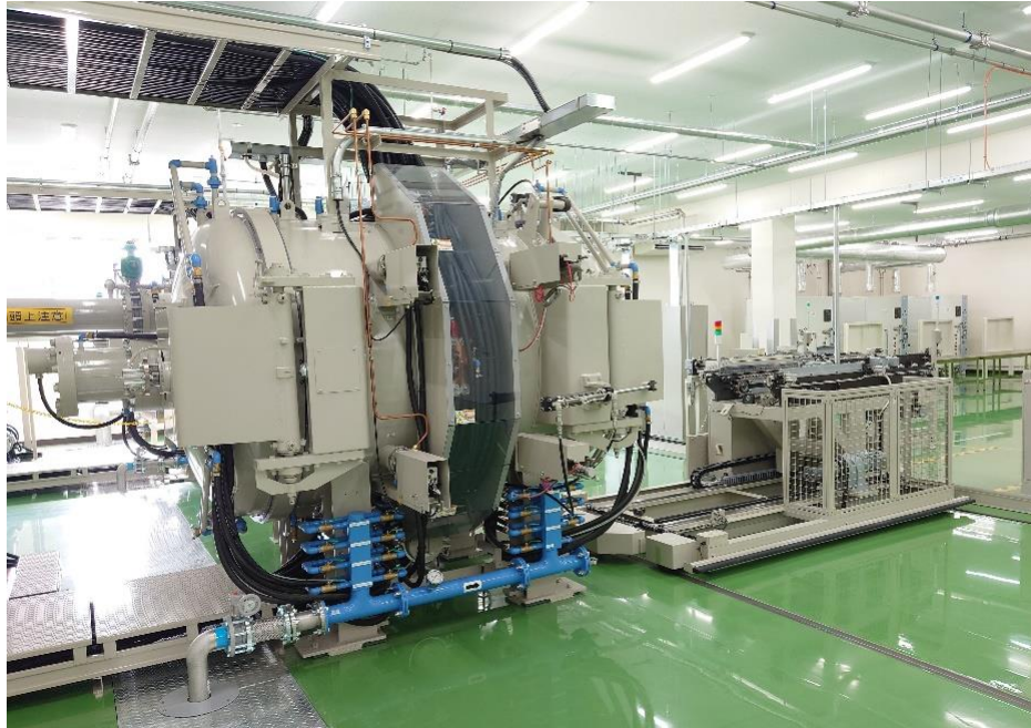
増設した焼成炉（いわき工場）
