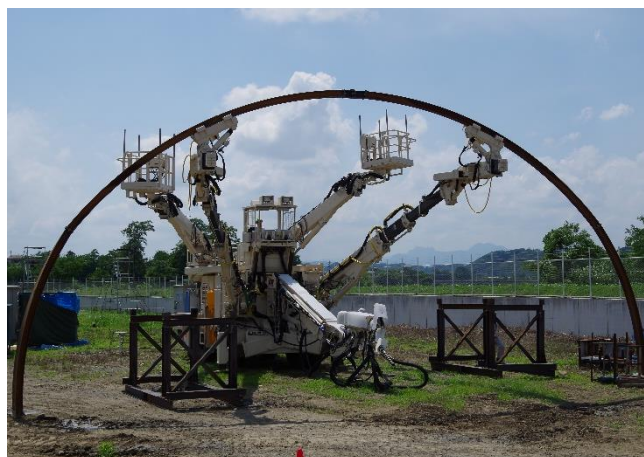
鋼製支保工建込みロボット
