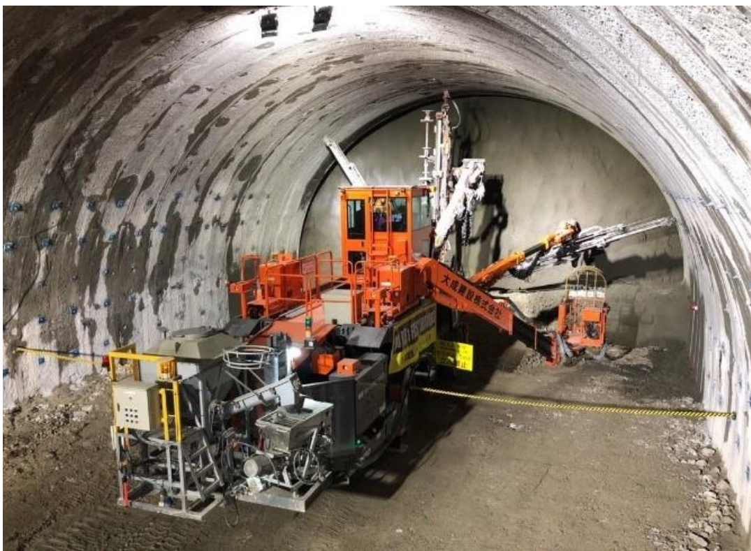
6m継ぎボルト打設装置を搭載したロックボルト専用機「BOLTINGER」
