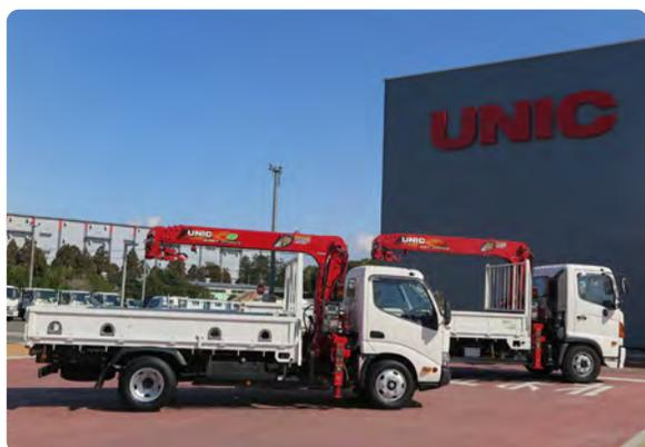
ユニック部門は、車両搭載型クレーンであるユニッククレーンやミニ・クローラクレーン等を製造・販売しています。ユニッククレーンは、トラックに搭載することで「吊る・積む・運ぶ・作業する」の一連の作業を、画期的なまでに効率化した荷役機械です。1961年に国産初の車両搭載型クレーンを開発し、その愛称の「ユニック」は、車両搭載型クレーンの代名詞となるほど日本では知名度を得ています。常に最先端の技術を取り入れ作業性や安全性にこだわり、たゆみなく改良を続けてきたことが、今の高い国内シェアにつながっています。現在は、高機能化・高付加価値化による競争力強化、海外の販売力強化に取り組んでいます。
